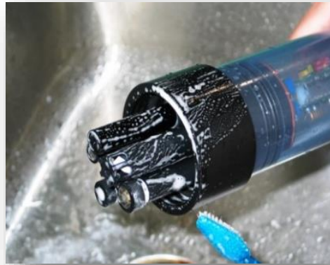
Figura 2 – Enjuague de una sonda multiparamétrica HyQual
