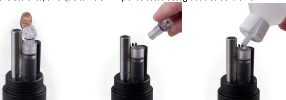
Figura 4 – Llenado de electrolito de referencia de pH fresco
